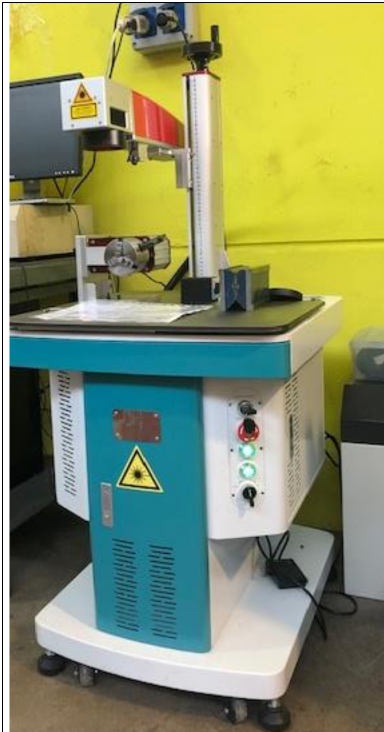
Figura 1 – La marcatrice laser per la stampa
