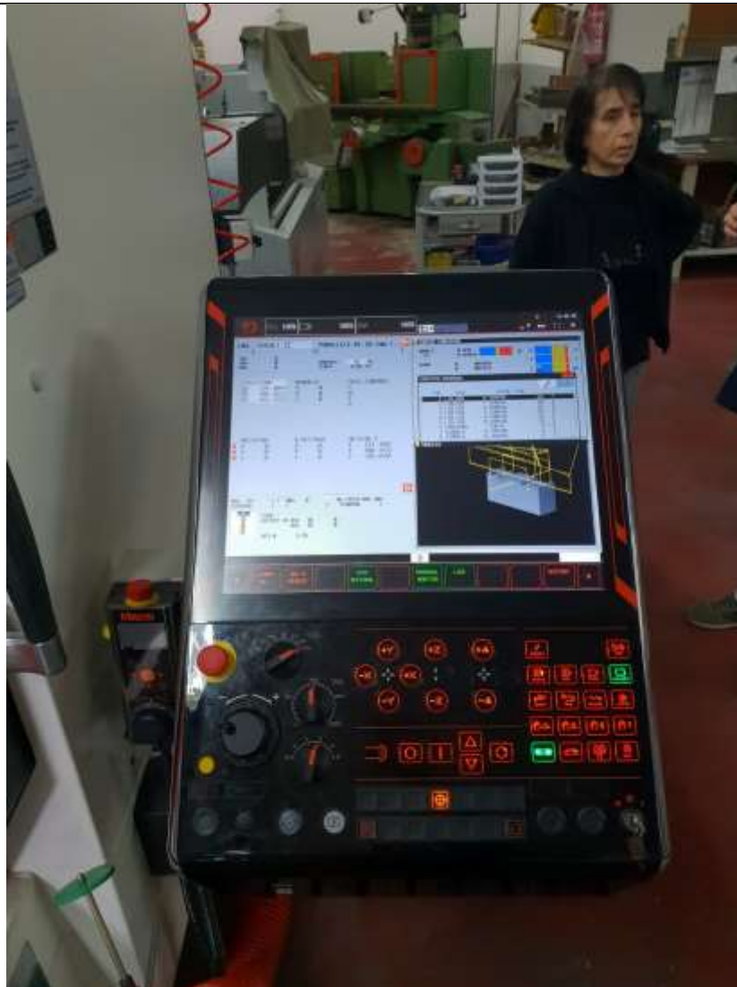
Figura 4 interfaccia HMI a bordo macchina
