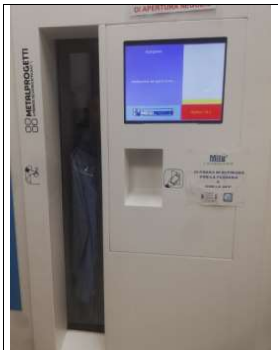
Figura 1 - porta Battista 24 H - sportello riconsegna con PLC e lettore ottico
